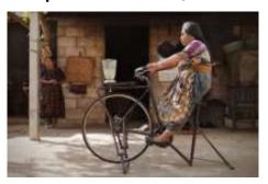
Pedal, une initiative qui roule! Cette ONG guatémaltéco-canadienne a pour but de retaper des vélos usagés pour les revendre ou mieux encore les transformer en d'astucieuses « bici-machines ». Fonctionnant exclusivement avec l'énergie générée par un coup de pédale, les engins fabriqués produisent suffisamment d'électricité pour alimenter une pompe à eau, un mixeur, une ponceuse, un broyeur et bien plus encore.
